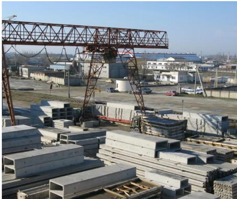
Железобетонные конструкции изготавливаются в соответствии с требованиями ГОСТов и технологических условий на конструкции конкретных видов. Завод выпускает более 350 м<sup>3</sup> железобетона в день. Входной контроль посту-
